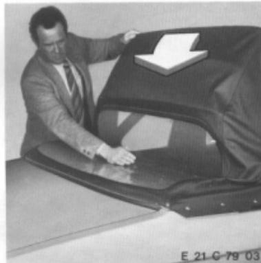
Die verwendete Polyglas-Heckscheibe ist ein chemisches Produkt und hat neben dem Vorteil einer hohen Flexibilität den Nachteil einer relativ weichen Oberfläche, insbesondere wenn sie höheren Temperaturen ausgesetzt ist.
