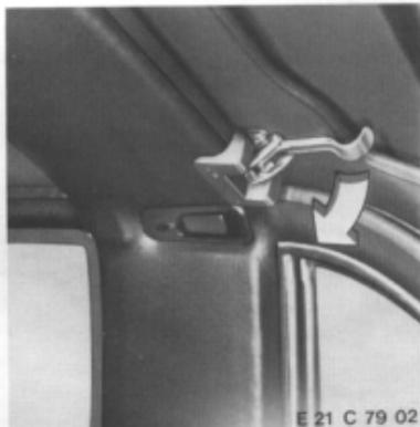
Spannbügel aushängen und Faltdach zurückklappen.
